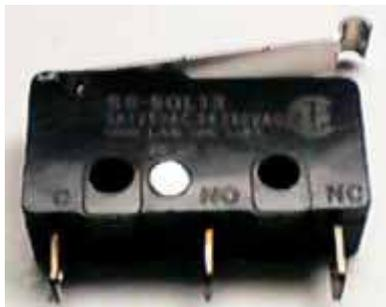
接点形リミット・スイッチは、金属接点を用いたスイッチに用途に応じた機構を組み込んだものである。種類が豊富な上、安価で入手も容易で、極性(プラス・マイナス)も気にしなくて良いなど、もっとも多く用いられるが、反面、金属接点を用いているため、接触不良や寿命などのトラブルも多く、特に油分や湿気の多い場所には不向きである。
