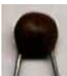
磁器コンデンサ(セラミックコンデンサ)は、チタン酸バリウムなどを焼いて作った磁器製の円盤を銀電極で挟んだものを絶縁塗料や合成樹脂で覆ったもので、誘電率が非常に高く、小型で比較
