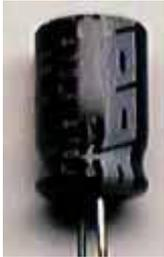
電解コンデンサ(ケミカルコンデンサ)は、誘電体として電解液を利用したものであり、コンデンサというよりも蓄電池(バッテリー)に近い。そのため、大きさに対する容量は最も大きいですが、耐圧が小さく、極性があり、液漏れの可能性があり、高周波特性は最悪である。それでも使われるのは小型で安価で容量が大きいためであり、主として大きな容量の必要な低周波増幅回路や交流を直流に変換する整流後の平滑回路に使われる。電気二重層コンデンサは、電解コンデンサの電解酸化膜の代わりに電気二重層を利用したもので、さらに容量が大きいが高周波特性が悪い。こちらは、短時間のメモリ(記憶装置)の記憶保持回路(バックアップ回路)などに使われている。
