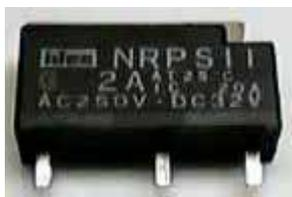
熱膨張率の異なる2種類の金属板を張り合わせたバイメタルが温度上昇により曲がることを利用して、バイメタルに電流を流し、曲がりがある一定を越えた際に遮断するようになっている。比較的小型で安価であるが、あまり定格電流の大きいものは存在しない。また、遮断と復旧を繰り返すと定格電流以下で遮断するようになることがある。
