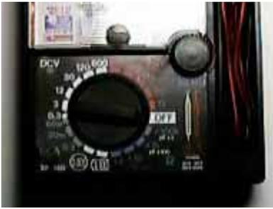
回路計(テスタ)は、1台で電気回路のさまざまな故障診断ができる最も基本的な小型の計測器である。一般的に直流電圧、交流電圧、直流抵抗、直流電流などを切り替えて計測することができる便利な計測器であるが、切り替え式であるためと、小型で簡易な計測器であるために、実際の使用に際しては次のようなことに注意する必要がある。
