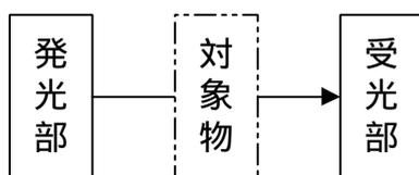
図2-3 透過形光電スイッチの原理
